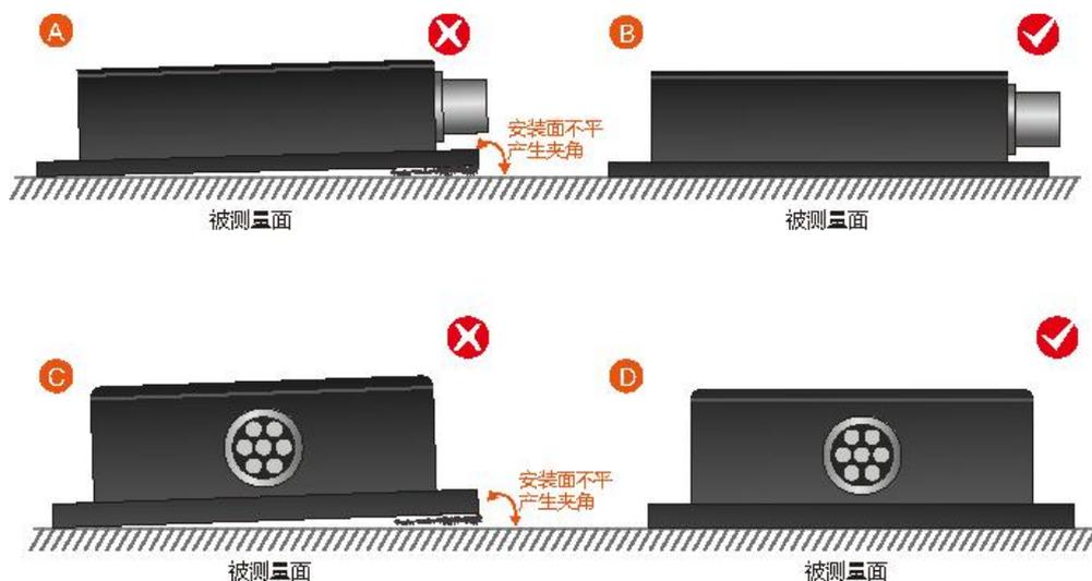
最后，组合导航系统和机体紧密贴紧后，使用螺丝固定，保证固定紧密、接触平整、转动稳定，要避免由于加速度、振动产生的测量误差。切记此时螺丝只起固定作用，不起定位作用，组合导航系统的螺孔被加工成椭圆形，便于调整。
